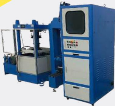
*Universal Testing Machine* (UTM) merupakan suatu alat uji untuk mengukur tingkat ketahanan, kekuatan tarik suatu bahan atau material. UTM ini digunakan untuk melakukan berbagai pengujian material menggunakan metode uji tekan (*compression*) maupun uji tarik (*tensile*). Umumnya material yang dapat diuji yaitu karet, logam, besi, batuan. Alat ini banyak digunakan pada bidang industri pertambangan, perminyakan, dan lainnya.
