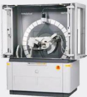
X-Ray Diffraction (XRD) adalah teknik analisis cepat non-destruktif yang digunakan untuk mengidentifikasi sampel saat fase kristal dan dapat memberikan informasi tentang dimensi unit sel (karakteristik material). Sampel yang dianalisis dapat berupa bahan padat (terutama yang mempunyai struktur kristal) berbentuk *powder* atau tepung.
