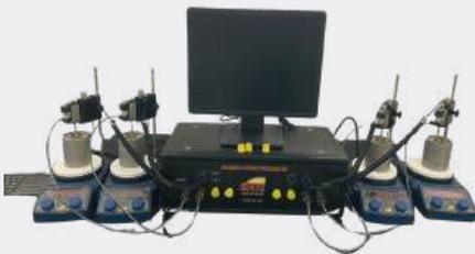
*Swell Meter* adalah alat yang digunakan dalam industri minyak dan gas untuk mengukur perubahan volume batuan pada saat terinfasi cairan. Alat ini berguna untuk memahami perilaku reservoir batuan bawah tanah ketika terjadi produksi minyak atau injeksi fluida ke dalamnya. Dengan mengukur perubahan volume batuan, *Swell Meter* membantu *engineer* perminyakan dalam mengoptimalkan produksi minyak dan gas serta mengevaluasi efektivitas metode injeksi fluida untuk meningkatkan produksi.
