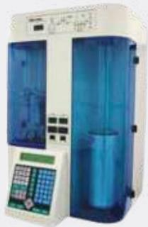
*Surface Area Analyzer* (SAA) berfungsi untuk menentukan luas permukaan material, distribusi pori dari material dan isotherm adsorpsi suatu gas pada suatu bahan. Analisis SAA sangat diperlukan dalam bidang aplikasi, antara lain
